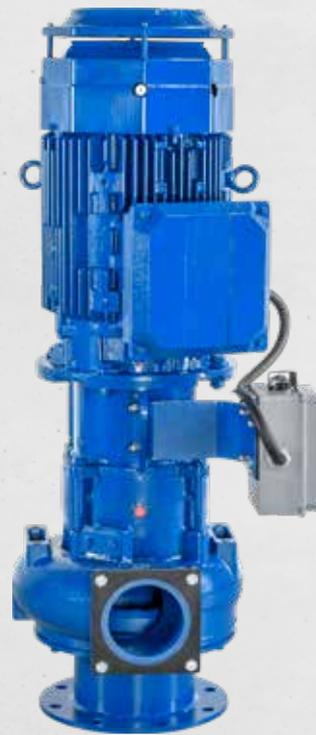
Die Eisele-Blockpumpe BP ist eine Kreiselpumpe in Blockbauweise. Sie wird trocken und wahlweise stehend oder liegend aufgestellt. Insgesamt stehen fünf Modelle mit Drehstrommotoren (Effizienzklasse IE3, wahlweise IE4) von 11 kW bis 30 kW zur Verfügung. Diese fördern bis zu 7.200 l / min und erreichen Förderhöhen von bis zu 25,00 m.
