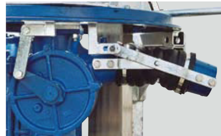
Rührdüse mit Strahlstabilisatoren, 45° nach oben und unten verstellbar (Sonderzubehör)
