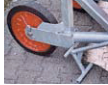
Spurverstellung mit Steckwelle (maximal 1,10 m) (Sonderzubehör)
