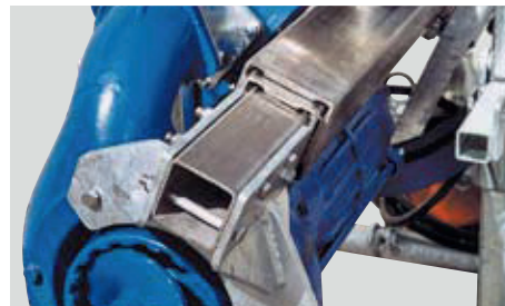
Edelstahl-Teleskopschiene (im Bild: drei Teleskopschienen für Grubentiefe 4,30)
